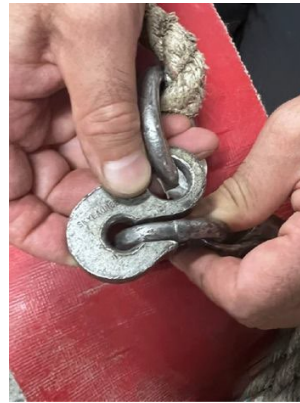
図 3 当該フックにトーストリングの太い側を当てた様子
